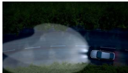
Aktivno prilagajanje svetlobnega snopa 'Ford Dynamic LED'
